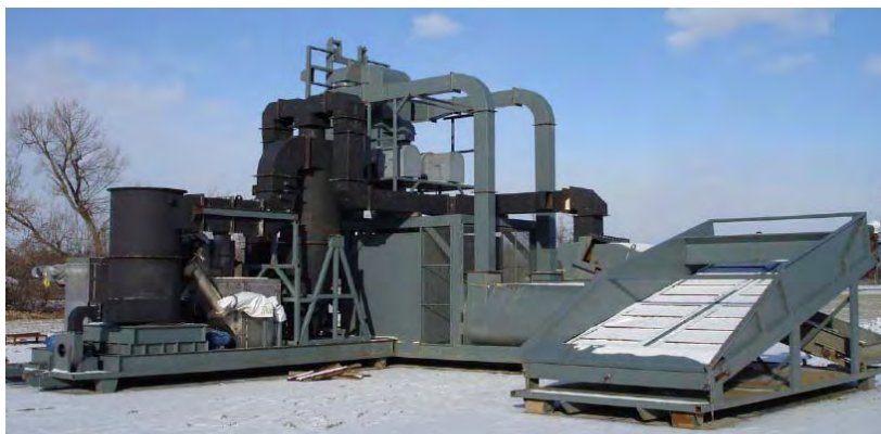
Photo 20 : Usine de pyrolyse mobile (50 tonnes par jour)
